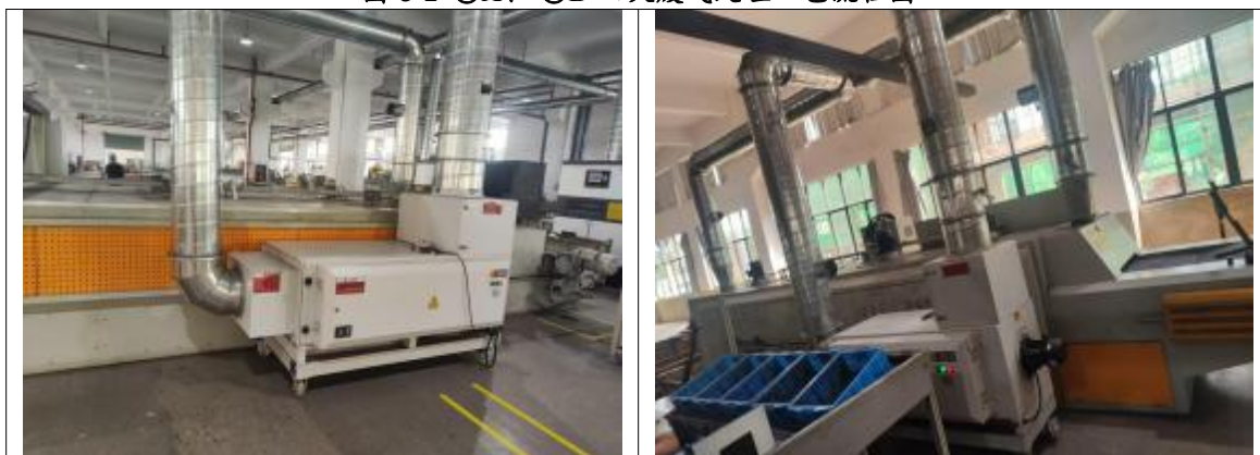
图 3-3 回火废气处理设施现场图
